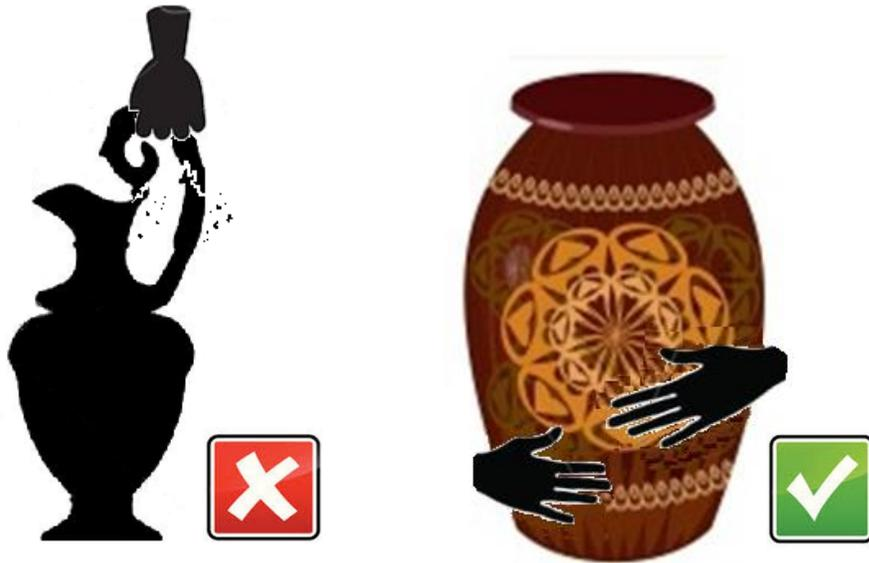
**Ilustración No. 7.** Forma incorrecta (izq.) y correcta (dcha.) de levantar una pieza cerámica.
