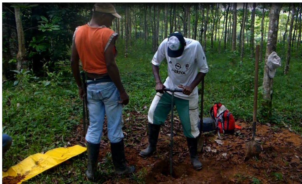
Ilustracion n° 13. Realización de pozos con barreno
