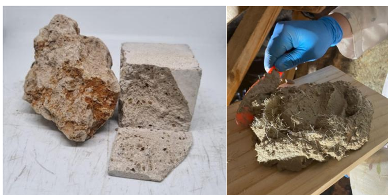
Ilustración 68. Se aprecia la semejanza entre el mortero fraguado y la toba volcánica de Tierradentro, También el mortero en proceso de ser aplicado mezclado con trozos de cabuya. Fotografías Lina María Méndez Arias y María Paula Alvarez
