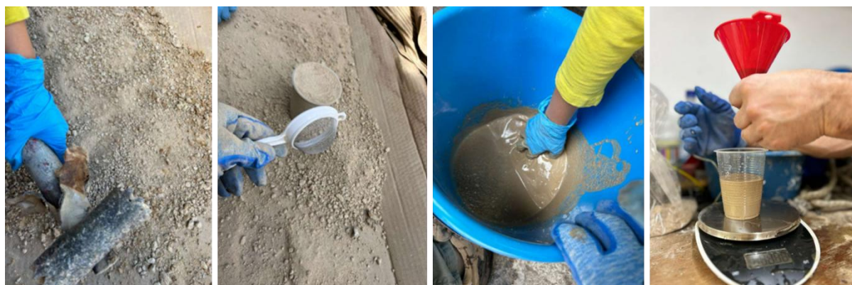
Ilustración 66. Ensayos para el desarrollo de la lechada de inyección para diaclasas, Fuente: Proyecto FIAN 2025-2026-Informe mes de noviembre, LINA MARÍA MÉNDEZ ARIAS.
