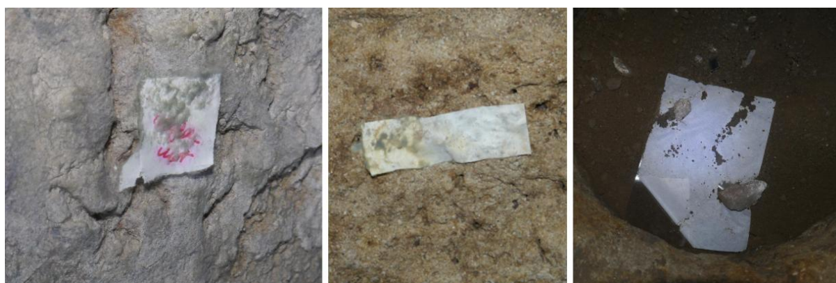
Ilustración 82. Materiales ajenos a los hipogeos que favorecen el desarrollo de colonias fúngicas dada dados sus componentes como la celulosa o adhesivos. Cintas de papel en S12 y S30 y hoja de papel. Fotografías tomadas por Antonio Guarnizo-Pérez.
