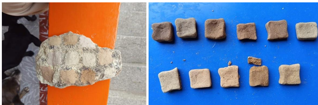
Ilustración 50. Once probetas de mortero, M1 - M11, en orden de izquierda a derecha y de arriba hacia abajo. A la derecha, el trozo de toba con las diferentes aplicaciones.
