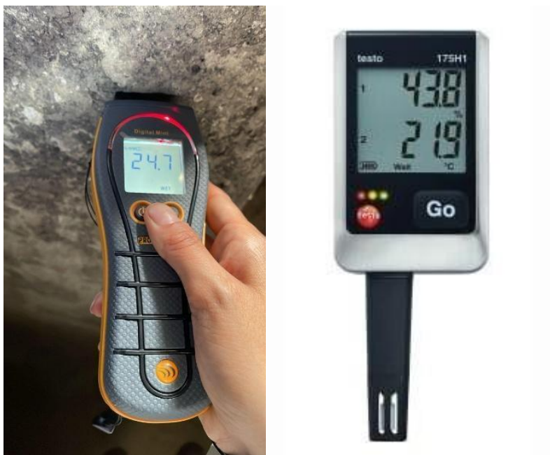
Ilustración 97. Equipo datalogger Testo 175-H1 y protímetro
